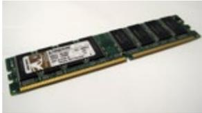
**Memoria RAM:** Es un almacén temporal de los datos que el microprocesador está utilizando para sus cálculos. El tipo de microprocesador y de placa base que lleva el ordenador indican qué cantidad de memoria RAM pueden manejar. La capacidad de almacenamiento de la memoria se mide en Megabytes (MB) o Gigabytes (GB)<sup>[9]</sup>. *Fotografía: Matt Kieffer. CC BY-SA 2.0*
