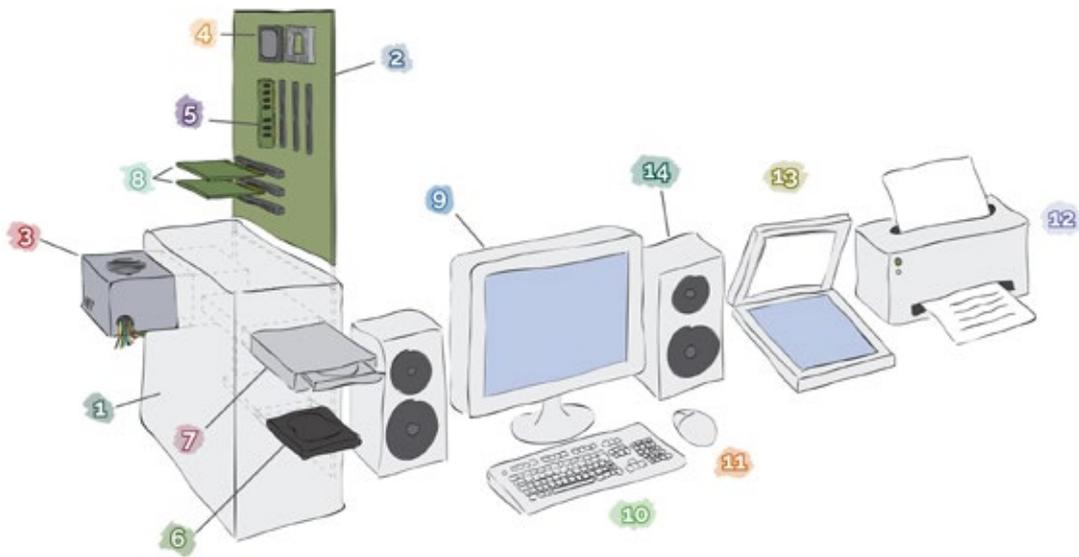
1. Carcasa exterior / 2. Placa base / 3. Fuente de alimentación / 4. CPU / 5. Memoria RAM / 6. Disco duro / 7. Lector óptico / 8. Tarjeta de vídeo, sonido, etc. / 9. Monitor / 10. Teclado / 11. Ratón / 12. Impresora / 13. Escáner / 14. Altavoces
