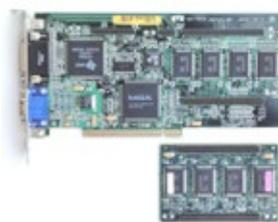
**Tarjeta de video y tarjeta de sonido:** Contiene un pequeño procesador, que ayuda al CPU a procesar y mostrar material audiovisual. Muchos ordenadores tienen una tarjeta de video integrada en la placa base. Los programas software de edición de video y de simulación de imágenes en 3D requieren gran capacidad en estas tarjetas; para usos cotidianos, una tarjeta integrada es suficiente. *Fotografía: Kashichan. Dominio público*
